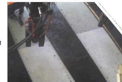
Проведены в НИУ МГСУ натурные огневые испытания ортотропной плиты из сплава 6082Т6 REI-45
