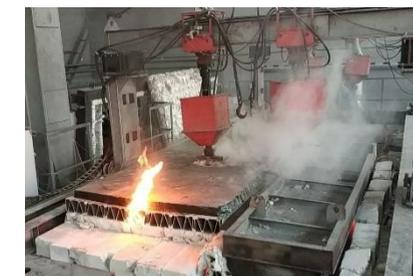
Проведены в НИУ МГСУ натурные огневые испытания алюминиевого профиля из сплава 6082Т6
