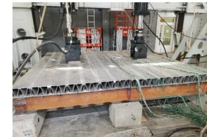
Разработана и испытана в МАДИ конструкция дорожной одежды для ортотропной плиты
